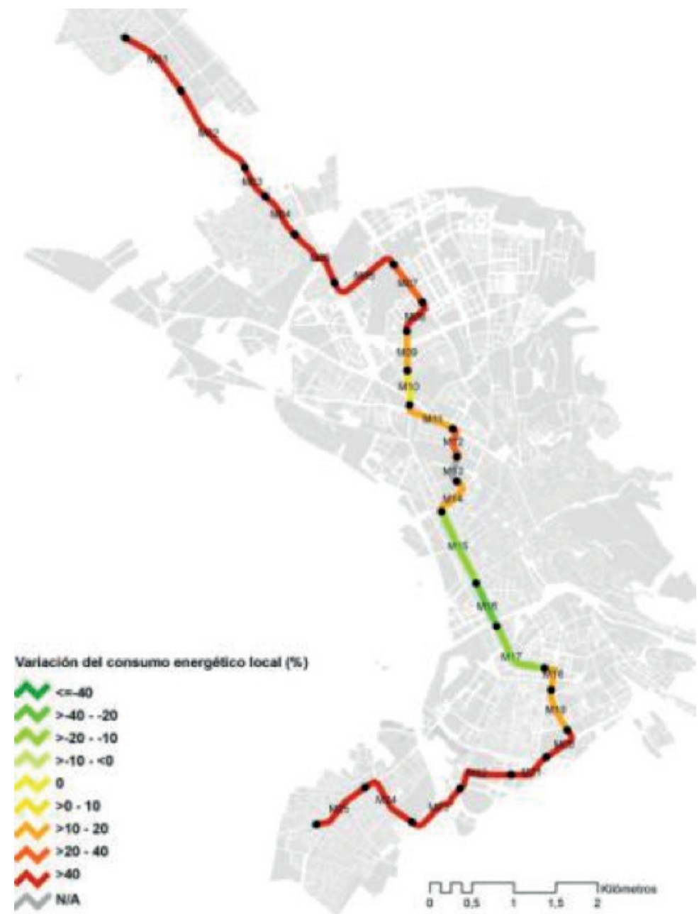
Figura 22. Variación porcentual del consumo energético local por tramo, tras la implantación de la línea 1 de Metro Ligero de Granada. Fuente: Ruiz, Valenzuela y Navarro (2010, p.61).
