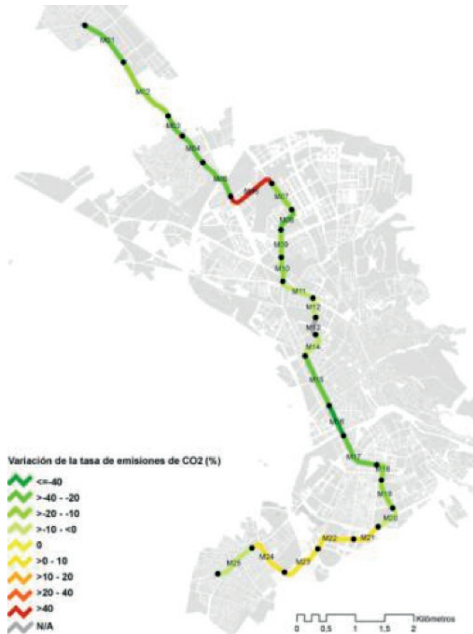
Figura 25. Variación porcentual de la tasa global de emisiones de CO2 por tramo, tras la implantación de la línea 1 de Metro Ligero de Granada. Fuente: Ruiz, Valenzuela y Navarro (2010, p.58).
