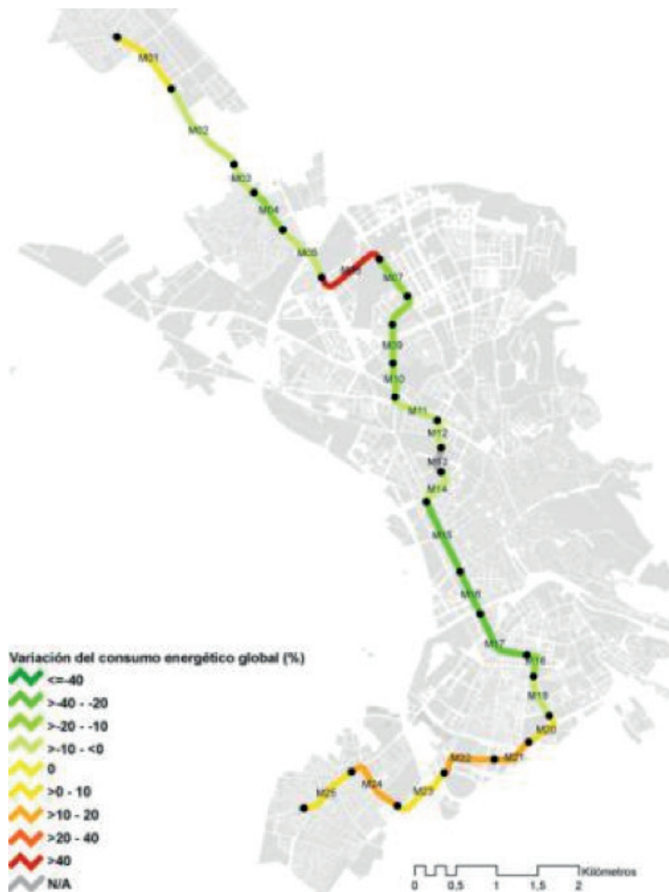
Figura 23. Variación porcentual del consumo energético global por tramo, tras la implantación de la línea 1 de Metro Ligerero de Granada.
